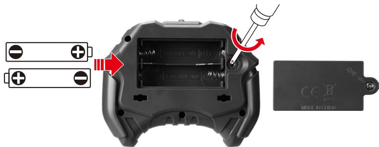
● 電池を入れる前に本体、コントローラーの電源スイッチを必ずOFFにしてください。
