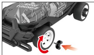
※必要以上に専用ネジを絞めないようにしてください。シャフトが破損する可能性があります。
