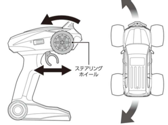
右ターン 前後進レバーを操作しながら、ステアリングホイールを右に回します。
