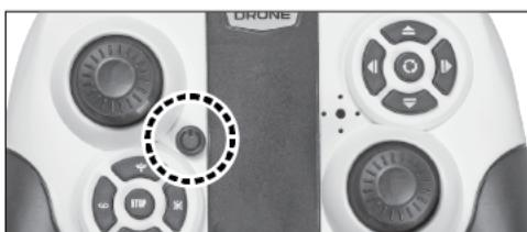
コントローラーの電源ボタンを1秒以上長押しするとコントローラーの電源ランプが消灯します。
