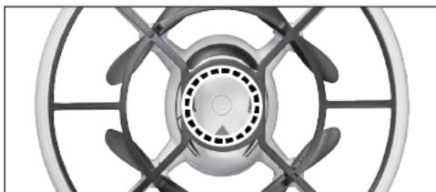
ドローン本体の電源ボタンを1秒以上長押しすると、ドローン本体のLEDが消灯し、電源オフになります。
