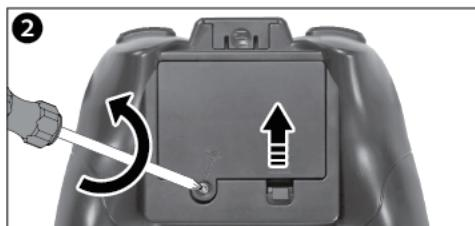
コントローラー裏面の電池カバーのネジを、プラスドライバーでゆるめ、電池カバーを外します。
