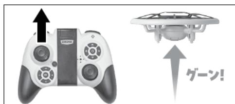
ドローン本体が離陸している状態で左レバーを更に上に倒すとドローン本体は10~15cmほど上昇します。左レバーを上に倒し続けるとドローン本体は一気に上昇します。
