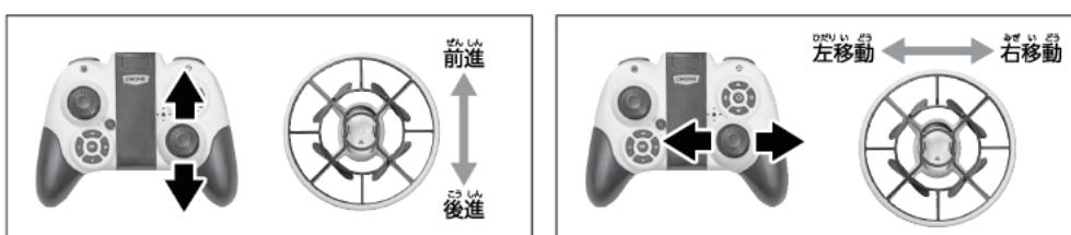
右レバーを上に倒すとドローン本体は前進、右レバーを下に倒すとドローン本体は後進、右レバーを右に倒すとドローン本体は右移動、右レバーを左に倒すとドローン本体は左移動します。上昇や下降と同じく、倒し続けるとドローン本体は一気に移動します。
