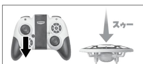
左レバーを下に倒すとドローン本体は10~15cmほど下降します。下に倒し続けるとドローン本体は一気に下降します。床に着くと自動的に着陸したと判断し、モーターが停止します。
