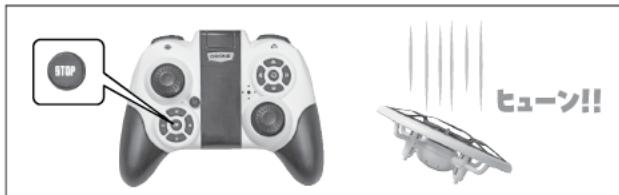
ワンプッシュ緊急停止ボタンを1秒以上押し続けると強制でモーターが停止し、ドローン本体がロックされます。人や物にぶつかりそうになった場合は、すぐにワンプッシュ緊急停止ボタンを押してください。
