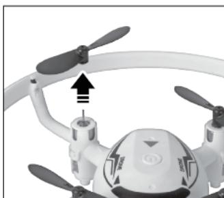
ドローン本体のカバーを外します。カバーを壊さないように注意してください。破損、変形したプロペラを取り外します。プロペラを金属ピンから引き抜きます。プロペラは非常に固く取り付けられています。交換するときは必ず保護者の方に交換してもらうようにしてください。予備のプロペラを金属ピンに取り付けます。金属ピンの奥までしっかりと取り付けてください。
