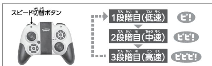
スピード切替ボタンを押すと、3段階のスピード調整ができます。
