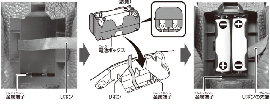
※電池ボックスを入れる際は、向きにご注意ください。間違った向きで入れると作動しません。作動しない場合は電池ボックスを取り出し、電池の向きと、電池ボックスの向きを再度確認し、入れ直してください。
