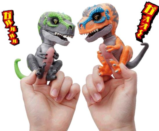
『手のり恐竜！ジュラミン！』は3つのセンサー（「タッチセンサー」「マイクセンサー」「スイングセンサー」）と、超小型モーターをわずか14cmのボディに搭載された小型電子ペットです。
